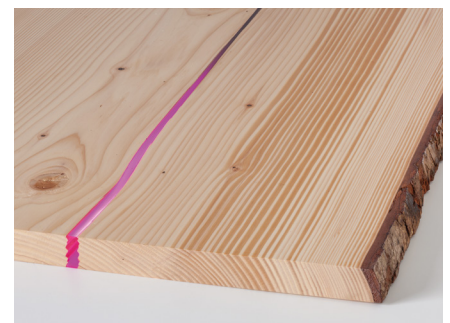
Farbakzent Riss mit Epoxidharz ausgefüllt
