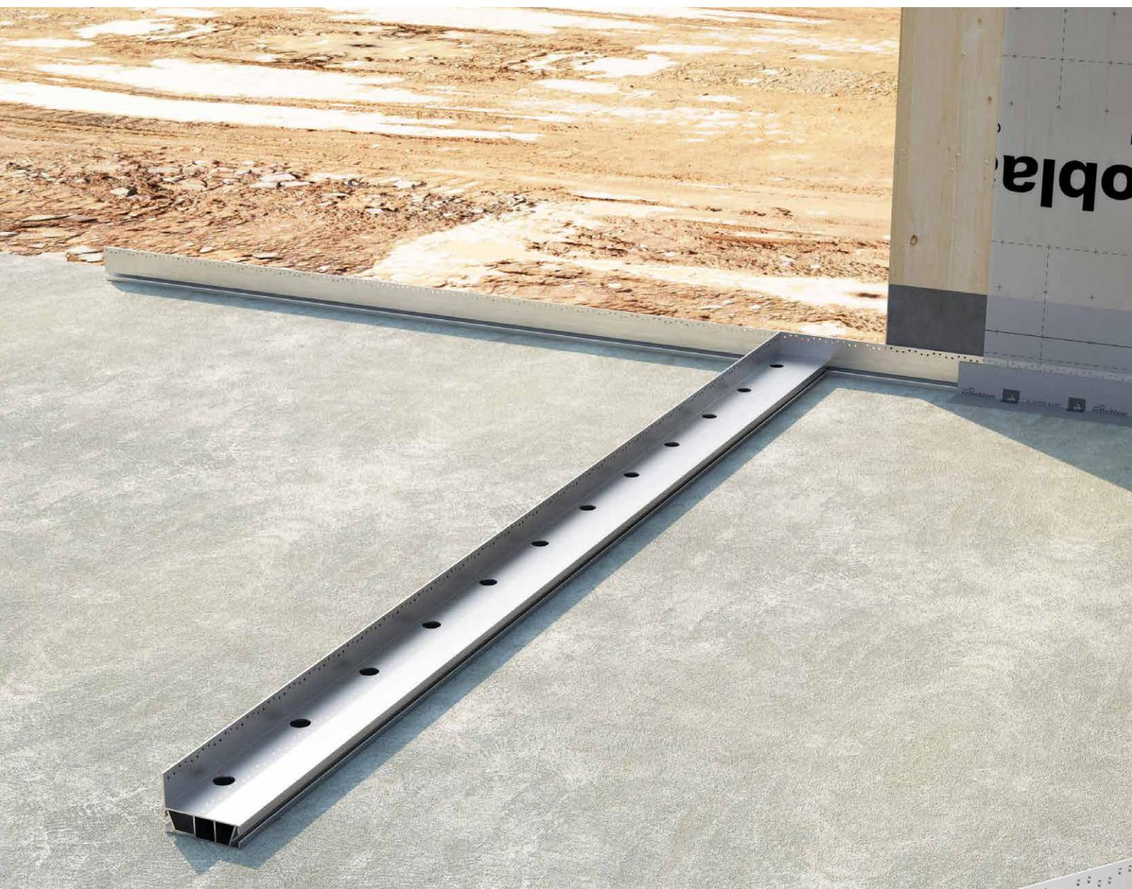
Das Profil ALU START erhöht den Abstand zwischen den Holzplatten und der Beton-Unterkonstruktion. Auf diese Weise wird der Schutz vor kapillarem Aufsteigen von Feuchtigkeit und eine ausgezeichnete Haltbarkeit der Richtschwelle des Gebäudes gewährleistet. Das erste Bodenverbindingssystem, das auf Druckplatten und scherfeste Winkelverbinder verzichten kann. Aus Aluminiumlegierung. Das System ALU START kann mit Wänden aus BSP oder Holzrahmenbau verwendet werden.
