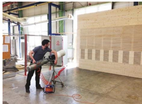
Geprüfte Paneele mit dem Absorber Steico Therm.
