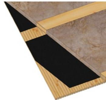
MARILYNE – Detail mit Fibertex 75 g/m² + Steico Flex 50 mm Dicke Rückseite der Platte
