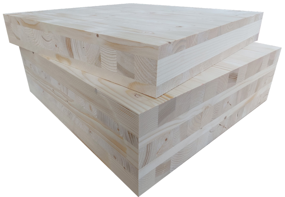
Drei- und fünfschichtige Brettsperrholzplatten mit Einzellagen aus Stäbchenlamellen der Sortierklasse T14 nach EN 14080:2013
