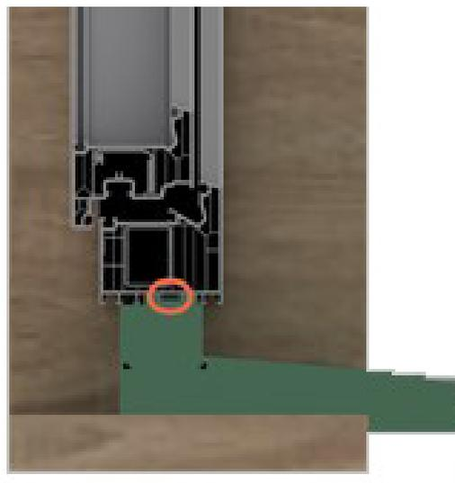
Die Elemente werden so vorbereitet, dass eine Montage der Fensterbänke sofort oder zu einem späteren Zeitpunkt stattfinden kann, und auch der Austausch von evtl. zerkratzten Fensterbänken ohne Beschädigung der zweiten Dichtebene bzw. der Fassade problemlos möglich ist.
