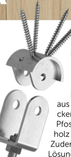
Das System RADIAL gewährleistet eine sichere Verbindung von Wänden, Trägern und Pfosten. Damit werden zwischen BSP- oder LVL-Platten, Verbindungen für Balken aus Brettschichtholz, Wänden und Decken aus BSP oder LVL, Trägern oder Pfosten aus Massivholz, Brettschichtholz oder LVL-Verbindungen hergestellt. Zudem lassen sich mit der patentierten Lösung Holz-Stahl-Konstruktionen mit komplexeren Anwendungen wie Gerberträger und gelenkigen Verbindungen ausführen.
