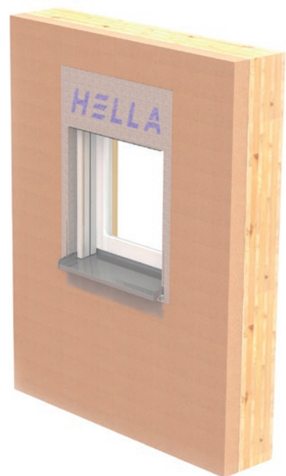
3. Fertigstellung des Systems mit Dämmung sowie Fensterbank innen und außen.
