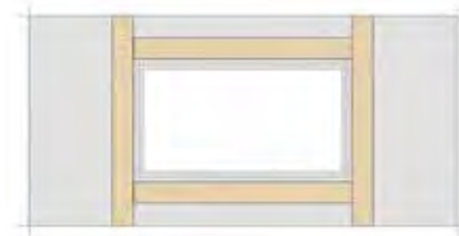
1. Umlaufende Holzbauteile/Füllholz im Bereich der Bauteilöffnung
